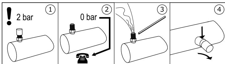
3 - Предупреждающее указание «Транспортный наполнитель» на клапане Шрадера
